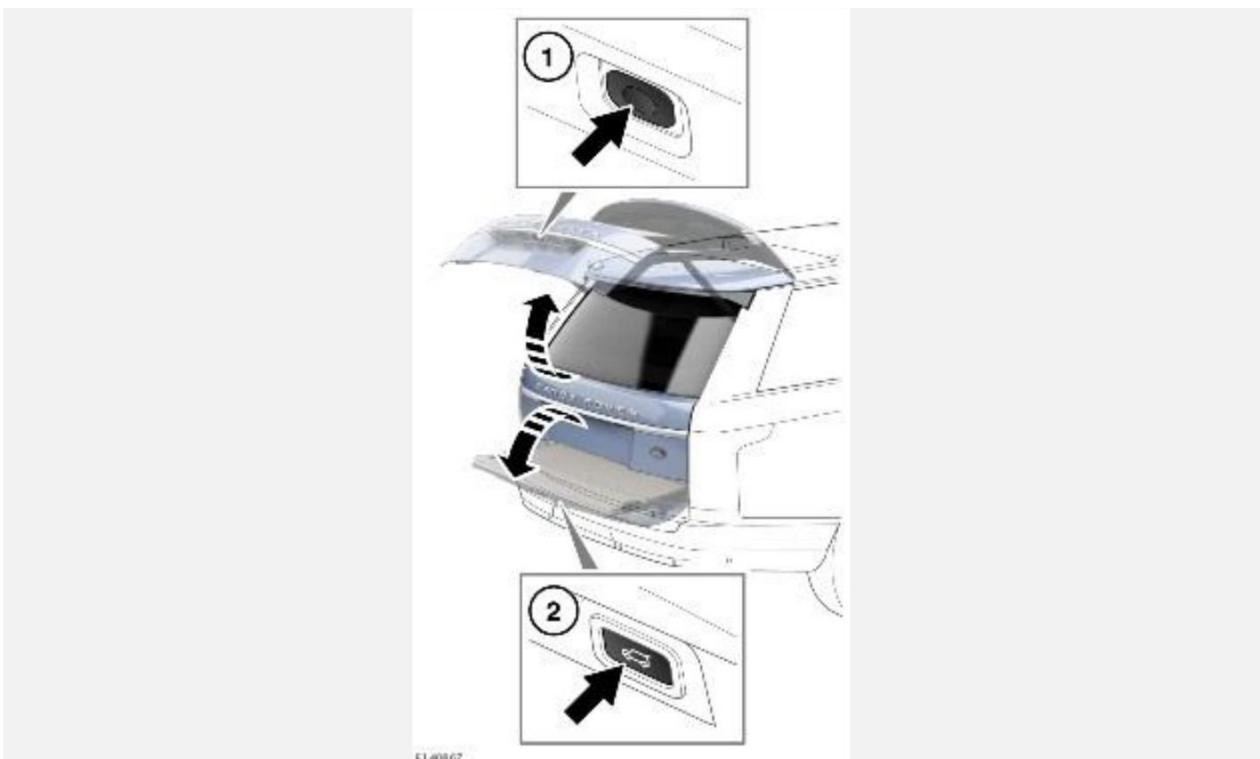
1. Кнопка открывания верхней секции двери багажного отделения: нажмите, чтобы открыть дверь багажного отделения. Поднимите дверь багажного отделения, чтобы открыть ее.
