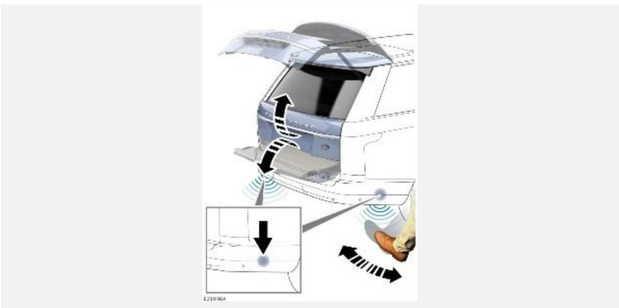
Датчики расположены в наружной части заднего бампера. Датчики распознают движение ноги ниже уровня бампера. Движение ноги обеспечивает автоматическое открывание или закрывание двери багажного отделения с электроприводом.
