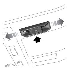
Электропривод потолочного люка работает, когда выключатель стартера находится в первом или во втором положении, а также в течение 16 минут после его перевода в выключенное положение (при условии, что ни одна из передних дверей не открывалась).
