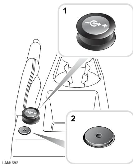
Гнездо дополнительного оборудования расположено в задней части средней консоли.
