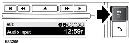
Для прослушивания источника с дополнительного входа подключите устройство и нажмите и удерживайте кнопку **CD** или **AUX** (Дополнительное) на аудиосистеме класса «Премиум». На стандартной аудиосистеме нажмите и отпустите кнопку **AUX**. Устройство начнет воспроизведение звука через стереогнездо 3,5 мм.
