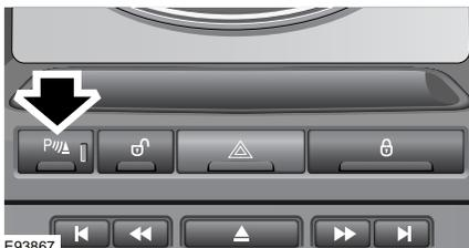
Для включения системы PDC вручную нажмите кнопку PDC, при этом включается короткий тональный сигнал подтверждения и загорается индикатор.
