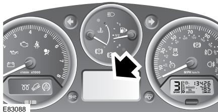
Главная информационная панель используется для передачи водителю информации, предупреждений и критических предупреждений.
