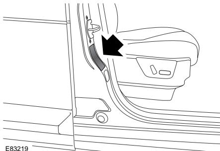
Требуемые значения давления в шинах показаны на табличке, прикрепленной к стойке со стороны двери водителя.
