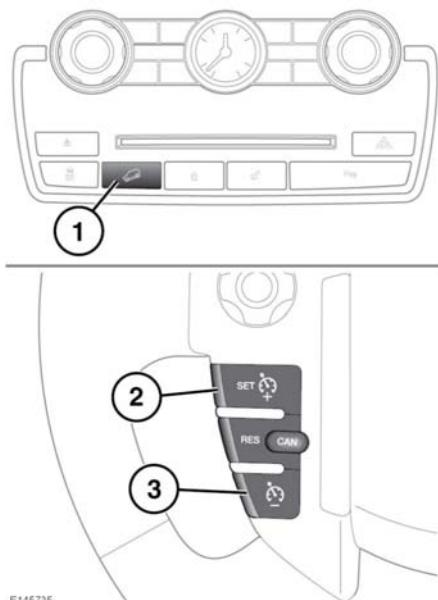
Система управления движением под уклон (HDC) позволяет ограничить скорость автомобиля до заданного значения при движении вниз по склону.
