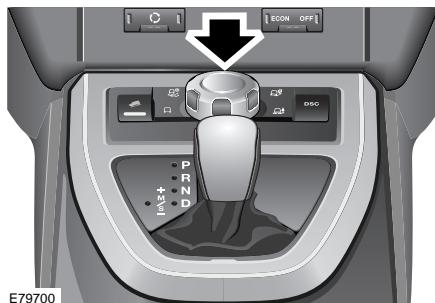
Для включения требуемой специальной программы используется ручка регулировки, находящаяся непосредственно перед рычагом КП. Когда ручка достигает конца выбранного диапазона в любом направлении, ее можно продолжать вращать, но уже без воздействия на систему.
