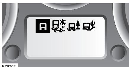
Специальные программы остаются активными в течение шести часов после выключения зажигания. Если зажигание включить в течение шести часов, данная программа снова активируется. Через шесть часов автоматически включается основная программа.
