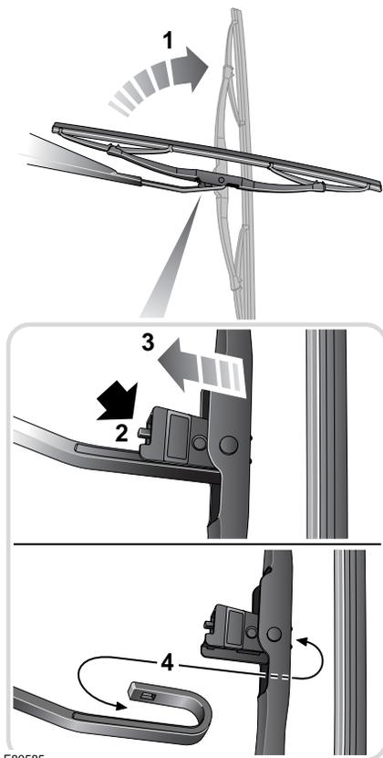
Отведите щетку стеклоочистителя от стекла. Снятие щетки стеклоочистителя производится следующим образом:
