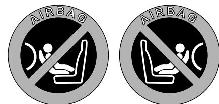
Этот символ крепится на конце приборной панели со стороны пассажира. Он означает, что запрещается использовать детское кресло, в котором ребёнок сидит лицом назад, при установленной и действующей подушке безопасности переднего пассажира.
