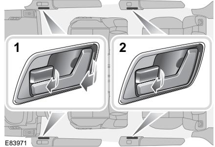
1. Передние двери можно отпирать при помощи дверных кнопок или отпирать и открывать при помощи ручек.
