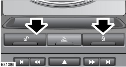
Для запирания или отпирания автомобиля нажмите соответствующую кнопку на приборной панели. При этом запираются или отпираются все двери, включая багажную.
