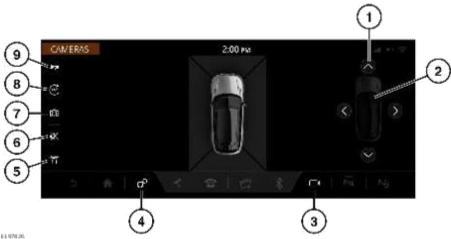
1. Стрелки выбора камер: стрелки вокруг автомобиля подсвечиваются при их выборе.
