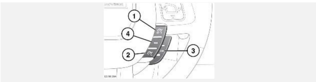
При включенной системе круиз-контроля на низких скоростях при движении на различных типах поверхности (ATPC) можно задать и отрегулировать целевую скорость автомобиля. Используйте для этого кнопки управления, расположенные с правой стороны рулевого колеса.
