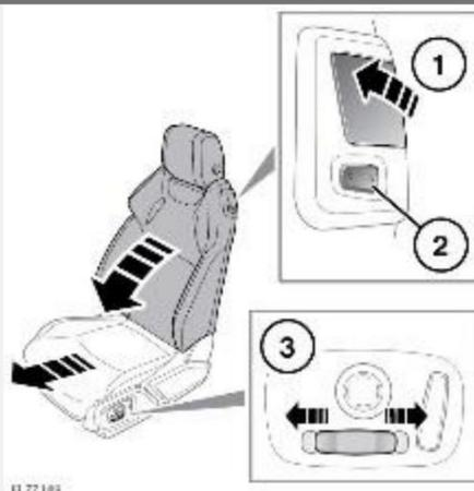
Чтобы наклонить спинку сиденья вперед, поднимите фиксатор блокировки (1).
