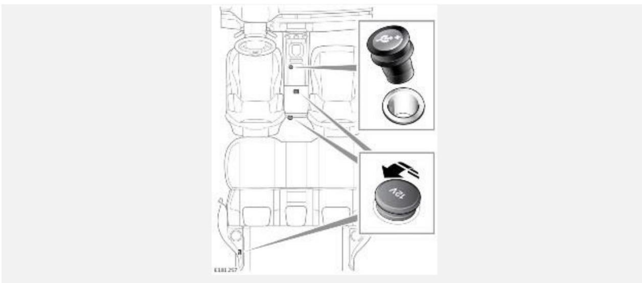
Снимите или поднимите крышку, чтобы получить доступ к гнезду питания напряжением 12 В.
