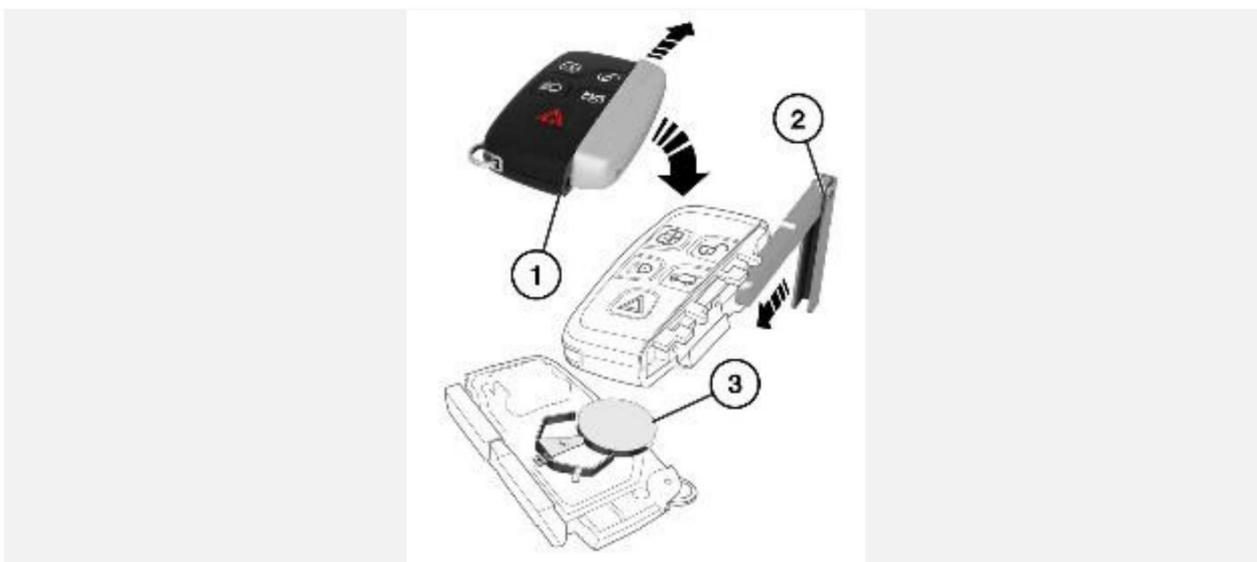
Уменьшение эффективного радиуса действия свидетельствует о необходимости замены элемента питания и сопровождается появлением на панели приборов сообщения **Smart Key Battery Low** (Разряжен элемент питания электронного ключа).
