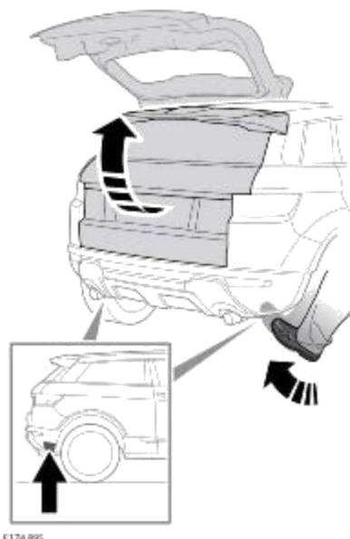
Датчики расположены в наружной части заднего бампера. Датчики распознают движение ноги ниже уровня бампера и обеспечивают автоматическое открывание или закрывание двери багажного отделения с электроприводом.
