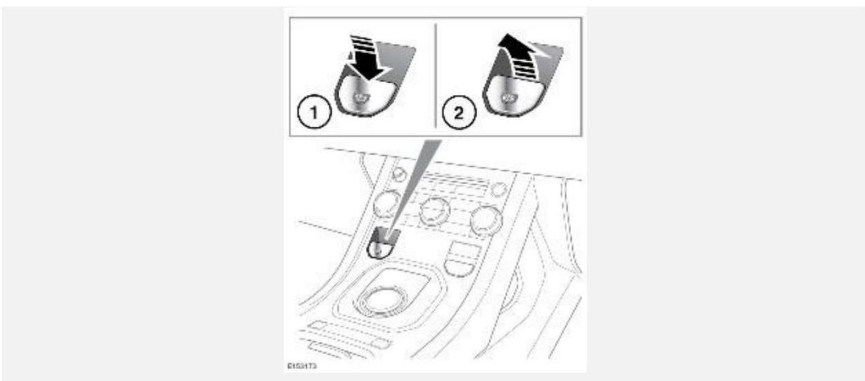
Переключатель EPB расположен на центральной консоли. Переключатель используется следующим образом:
