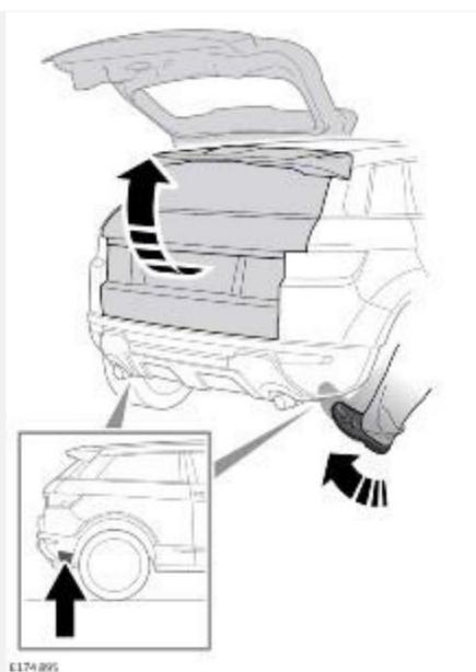
Датчики расположены в наружной части заднего бампера. Датчики распознают движение ноги ниже уровня бампера и обеспечивают автоматическое открывание или закрывание двери багажного отделения с электроприводом.
