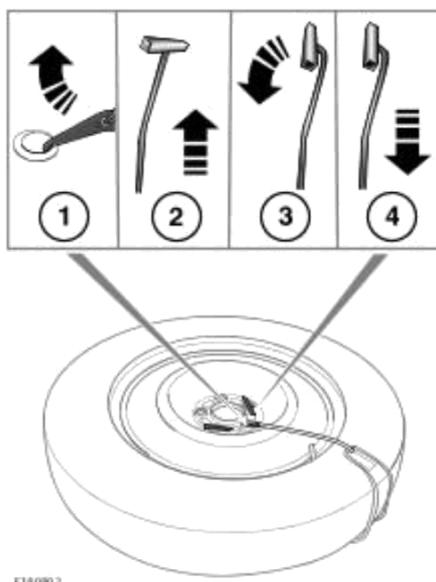
Перед установкой временного запасного колеса на автомобиль снимите трос временного запасного колеса. Для снятия троса временного запасного колеса:
