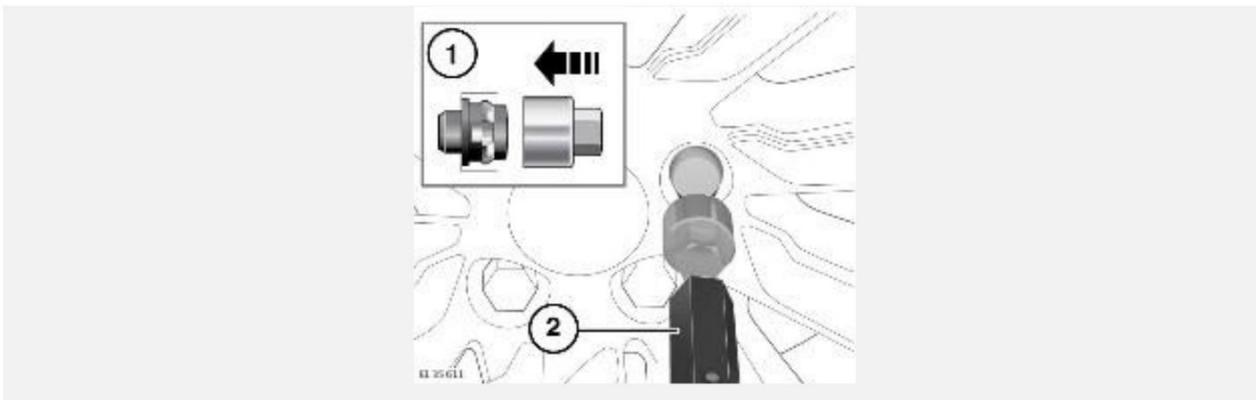
Секретные гайки крепления колеса можно снимать и устанавливать только при помощи специального переходника. См. [НАБОР ИНСТРУМЕНТОВ](#).
