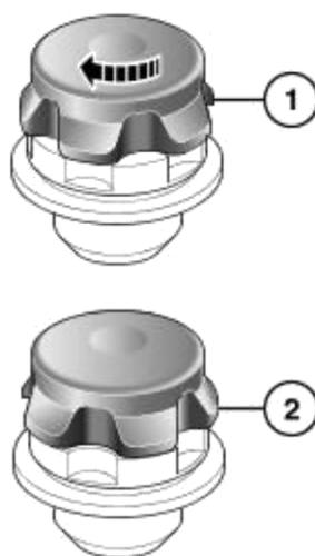
Переустановка крышки секретной гайки колеса выполняется следующим образом:
