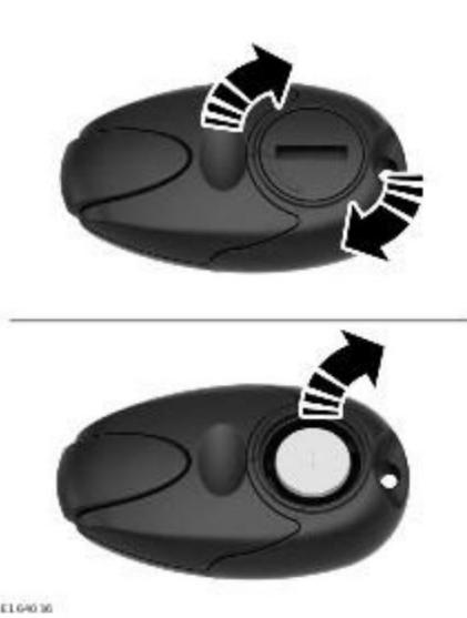
Перевернув пульт дистанционного управления задней стороной вверх, с помощью монеты или аналогичного предмета поверните крышку батарейного отсека. Снимите крышку. Под ней находится батарейный отсек. Извлеките старый элемент питания и, соблюдая правильную полярность, установите новый элемент питания CR1/3N с напряжением 3,3 В. Установите на место крышку и поверните ее, чтобы закрыть до фиксации.
