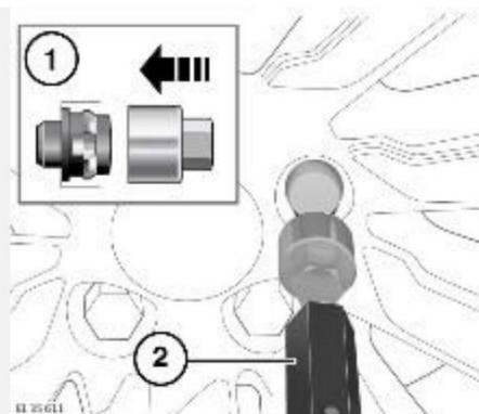
Секретные гайки крепления колеса можно снимать и устанавливать только при помощи специального переходника. См. [НАБОР ИНСТРУМЕНТОВ](#).
