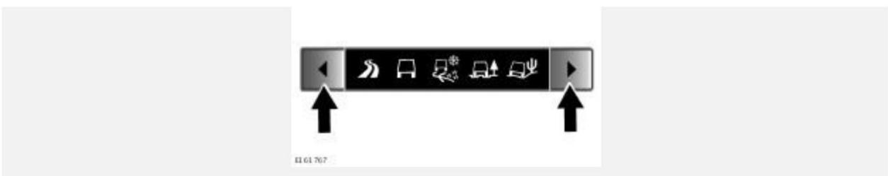
Используйте кнопки, расположенные на центральной консоли, чтобы переключаться между различными программами системы адаптации к дорожным условиям Terrain Response.
