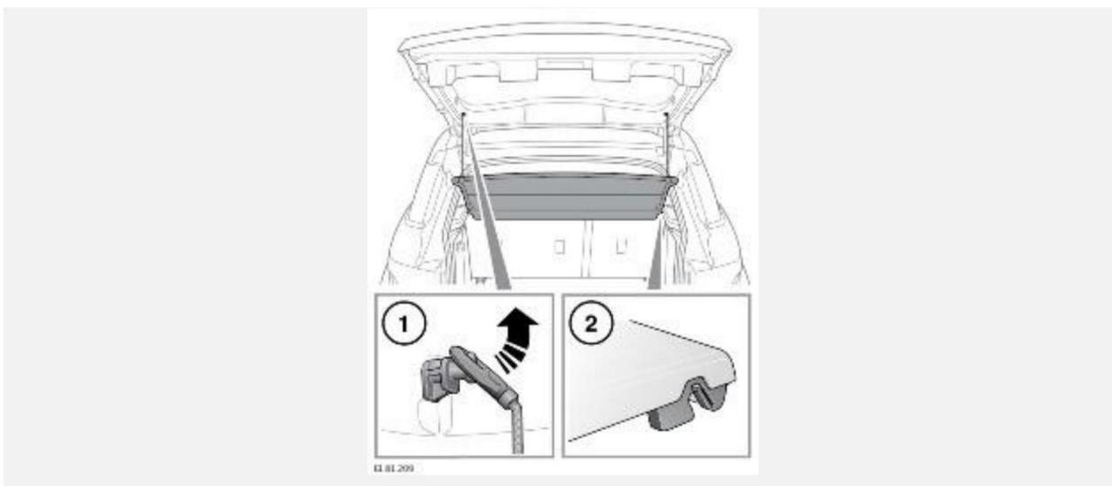
Снятие крышки багажного отделения:
