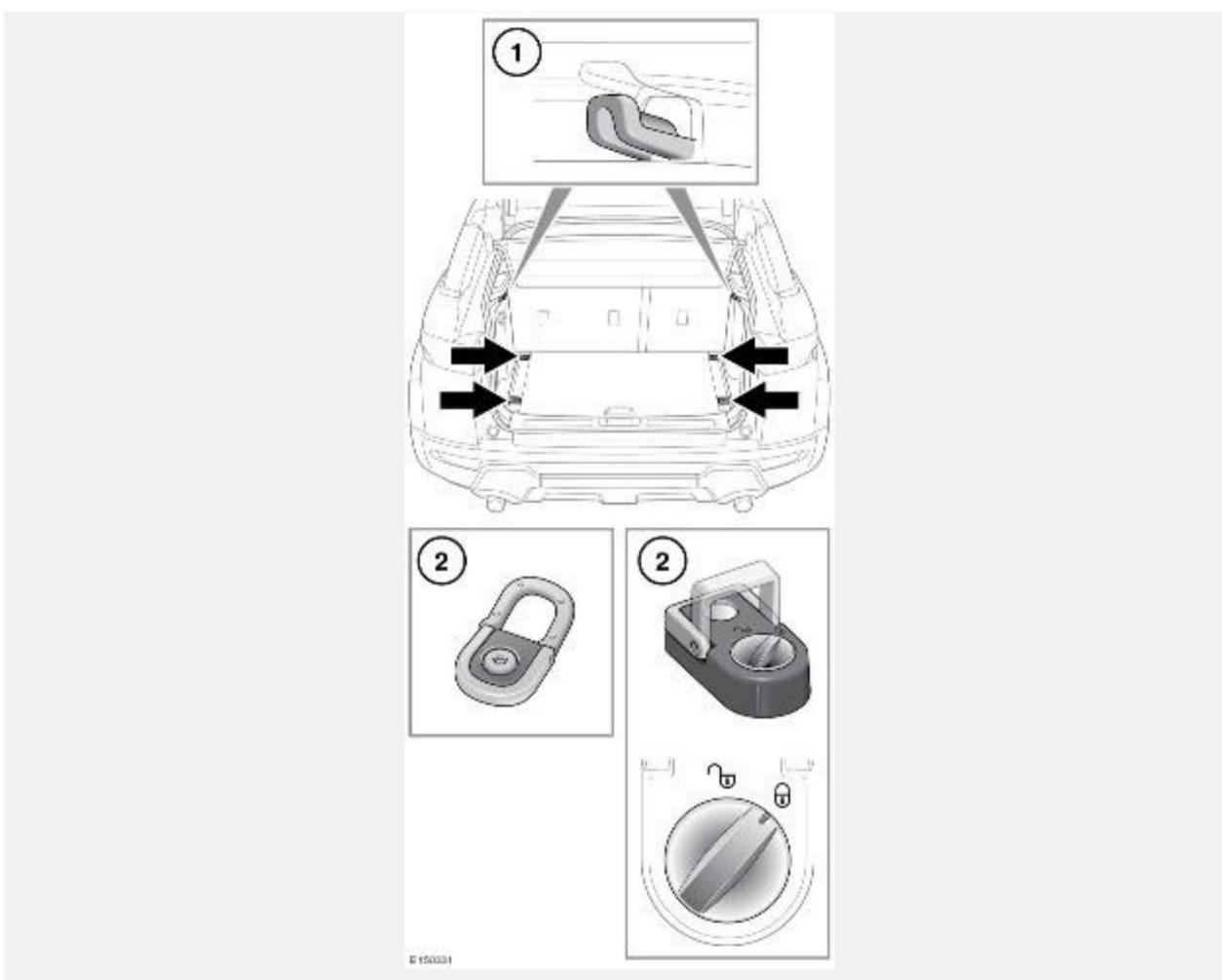
Использование неподвижных и регулируемых ползунков крепления:
