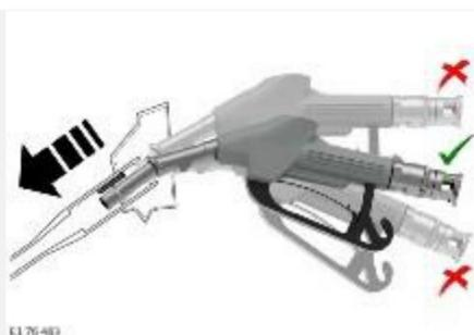
Автомобили с дизельным двигателем могут быть оснащены активным устройством топливной защиты. Металлический лючок виден в горловине топливного бака, когда снята крышка. Активное устройство топливной защиты помогает предотвратить залив в топливный бак топлива ненадлежащего типа, например, бензина. Автоматическое устройство обеспечивает доступ, если заправочный пистолет дизельного топливного насоса имеет надлежащий
