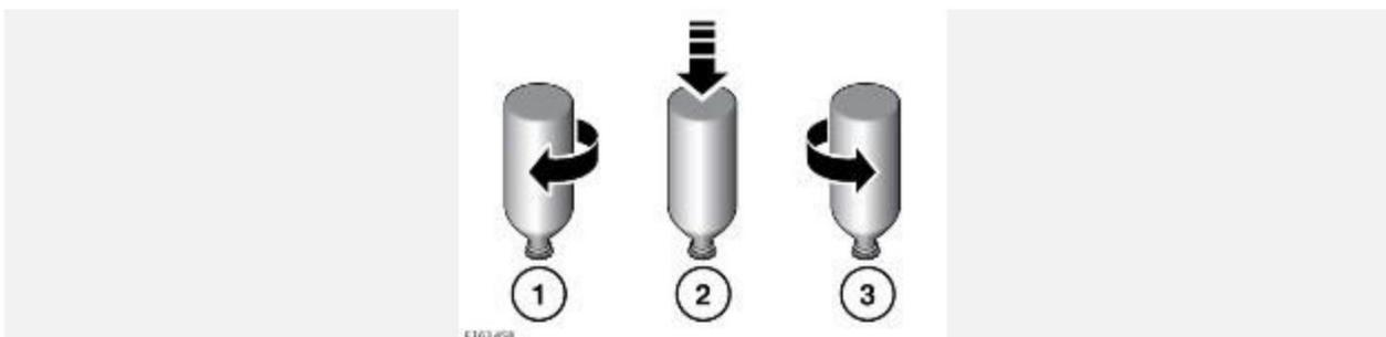
1. Установите многооборотную бутылку на воронку горловины и поверните ее по часовой стрелке, чтобы она зафиксировалась в таком положении.
