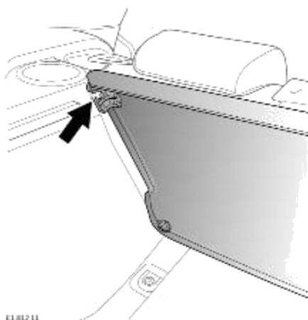
1. Снятие крышки багажного отделения.
