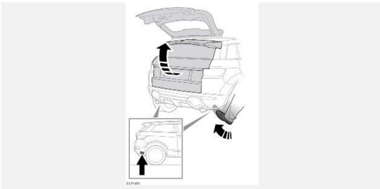
Датчики расположены в наружной части заднего бампера. Датчики распознают движение ноги ниже уровня бампера и обеспечивают автоматическое открывание или закрывание двери багажного отделения с электроприводом.
