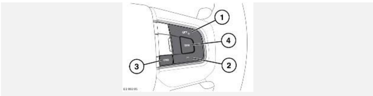
При включенной системе круиз-контроля на низких скоростях при движении на различных типах поверхности (АТРС) можно задать и отрегулировать целевую скорость автомобиля. Используйте для этого кнопки управления, расположенные с правой стороны рулевого колеса.
