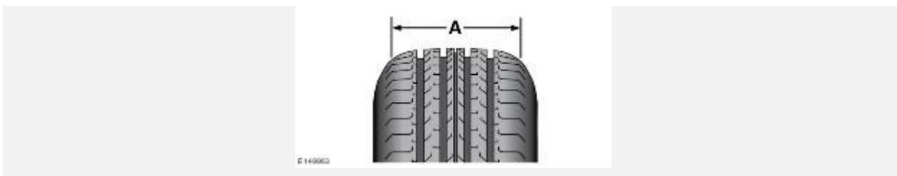
Система ремонта шин позволяет ремонтировать большинство проколов диаметром до 6 мм, если прокол находится в пределах зоны протектора (A).
