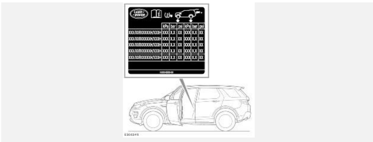
Рекомендованные значения давления в шинах для всех условий перечислены в табличке, расположенной в основании проема двери водителя. Кроме того, при наличии системы TPMS рекомендуемые значения давления в шинах можно посмотреть в разделе "TPMS" (Система контроля давления в шинах) меню "Vehicle info" (Информация об автомобиле).
