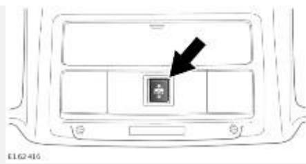
Переключатель открывания и закрывания шторки крыши:
