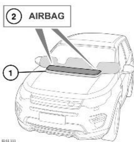
Некоторые автомобили могут быть оснащены подушкой безопасности пешехода. Подушка безопасности пешехода расположена под панелью в капоте. Слово "AIRBAG" (Подушка безопасности), расположенное по краям в задней части панели, подтверждает наличие подушки безопасности пешехода.
