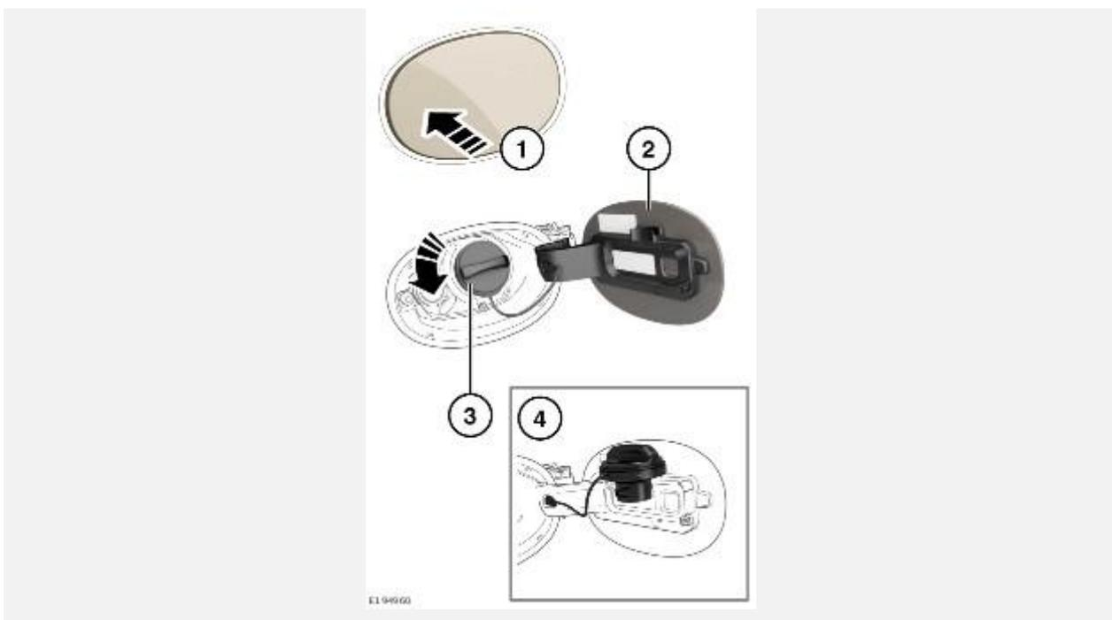
Лючок топливозаливной горловины расположен сзади, на правой стороне автомобиля. Выполните следующие действия:
