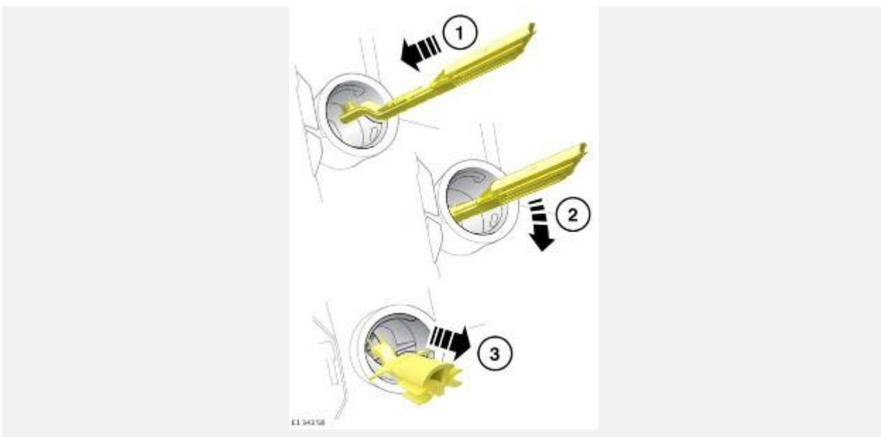
Используйте следующие инструкции инструмента для переустановки механизма защиты:
