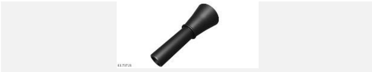
Автомобили с дизельным двигателем могут быть оснащены активным устройством топливной защиты. Металлический лючок виден в горловине топливного бака, когда снята крышка. Для заправки топливного бака из канистры потребуется использовать аварийную воронку, поставляемую с автомобилем. Полностью вставьте воронку в топливозаливную горловину вдоль ее оси, чтобы открыть активное устройство топливной защиты. См. [УСТРОЙСТВО АКТИВНОЙ ТОПЛИВНОЙ ЗАЩИТЫ ДЛЯ ДИЗЕЛЬНЫХ ДВИГАТЕЛЕЙ](#).
