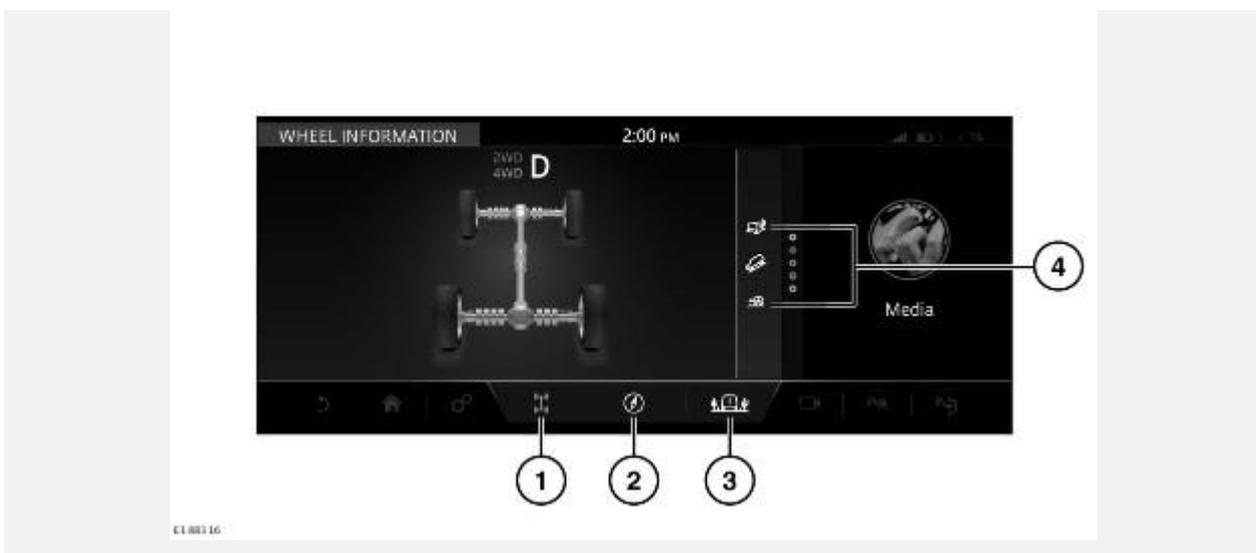
Выберите дополнительную функцию **4x4i**, чтобы получить доступ к информации о режиме полного привода (4WD), а также к рекомендациям по движению по бездорожью. См. [ДОПОЛНИТЕЛЬНЫЕ ФУНКЦИИ](#).
