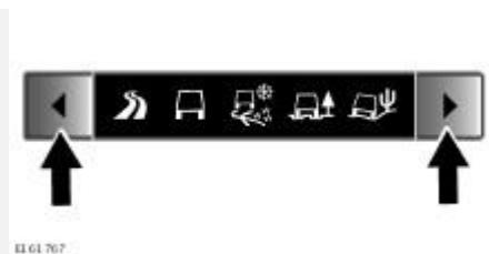
Используйте кнопки, расположенные на центральной консоли, чтобы переключаться между различными программами системы адаптации к дорожным условиям Terrain Response.
