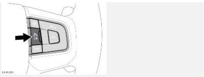
Нажмите кнопку **LIM** (Ограничитель) на рулевом колесе, чтобы включить систему ограничителя скорости.
