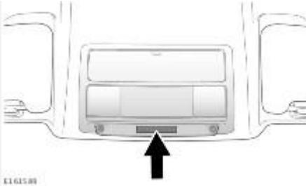
Индикатор состояния подушки безопасности на потолочной консоли отражает текущее состояние подушки безопасности пассажира в соответствии с приведенной таблицей:
