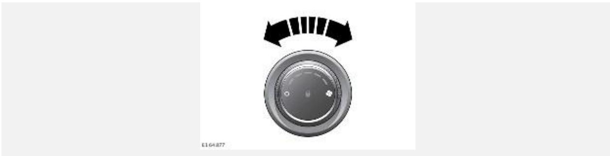
Поверните ручку, чтобы отрегулировать скорость работы вентилятора.
