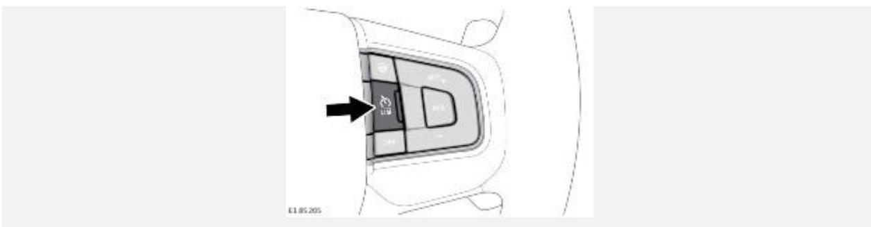
Нажмите кнопку **LIM** (Ограничитель) на рулевом колесе, чтобы включить систему ограничителя скорости.
