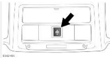
Переключатель открывания и закрывания шторки крыши:
