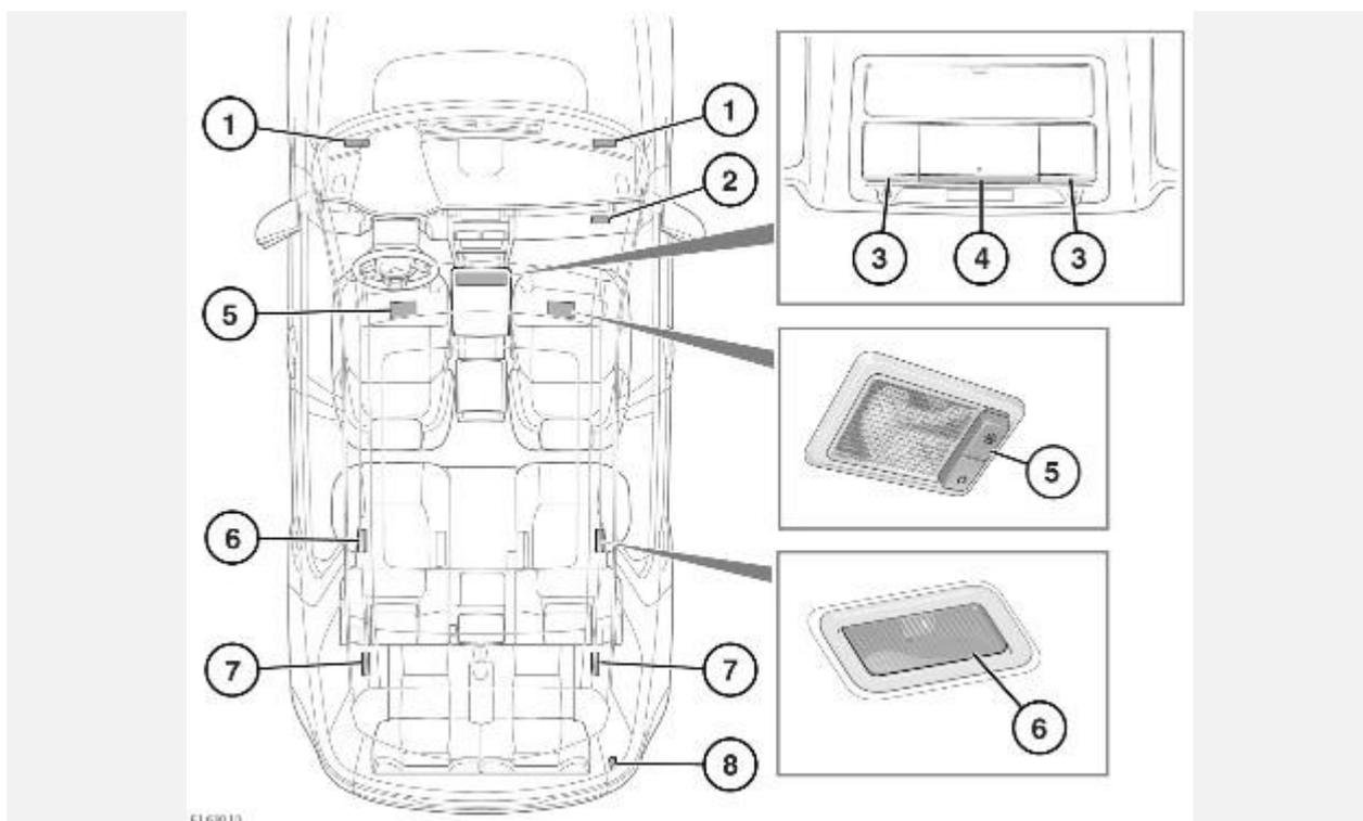
1. Плафоны освещения передних ниш для ног: включаются при отпирании дверей. Они выключаются примерно через 60 секунд после закрытия всех дверей, при запуске двигателя или заперении автомобиля.
