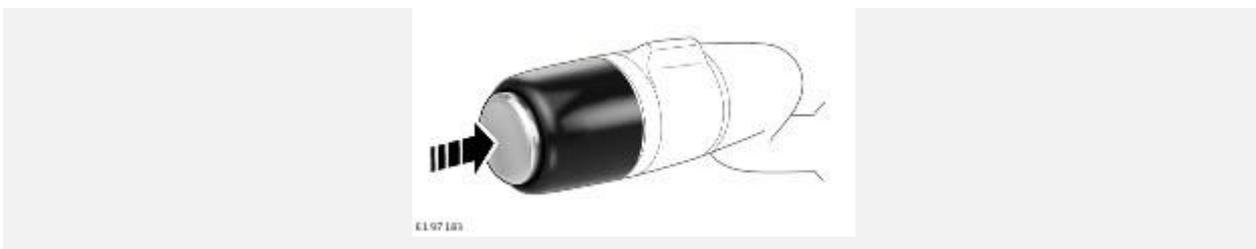
Нажмите и отпустите кнопку маршрутного компьютера для изменения опции отображения данных маршрутного компьютера на панели приборов.
