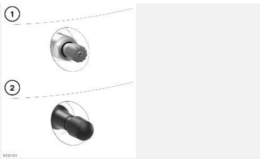
Колеса с системой TPMS можно отличить визуально по наружной металлической контргайке и ниппелю (1). На колеса всех автомобилей Land Rover, не оборудованных системой TPMS, ставятся обрезиненные ниппели (2).
