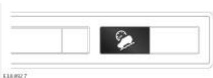
В автомобилях, оснащенных системой ATPC, кнопка системы контролируемого движения под уклон (HDC) выполняет различные функции. Кнопка выполняет переключение между функциями ATPC и HDC, а также включает и выключает каждую из этих функций. См. [ОБЗОР СИСТЕМЫ КОНТРОЛИРУЕМОГО ДВИЖЕНИЯ ПОД УКЛОН \(HDC\)](#).
