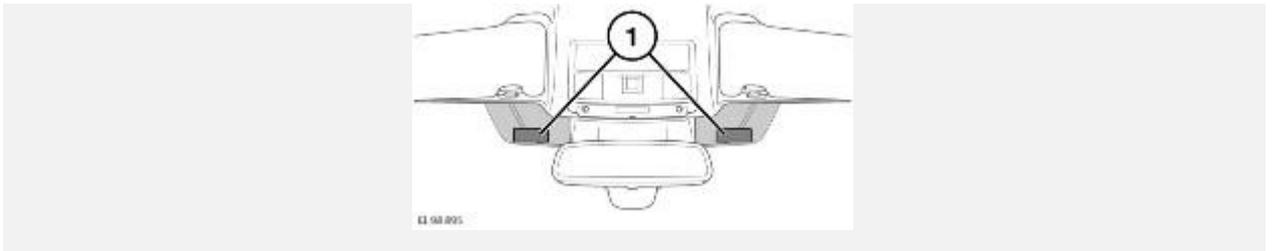
Атермальное ветровое стекло такого типа фильтрует солнечный свет, пропуская его через специальный слой внутри стекла.
