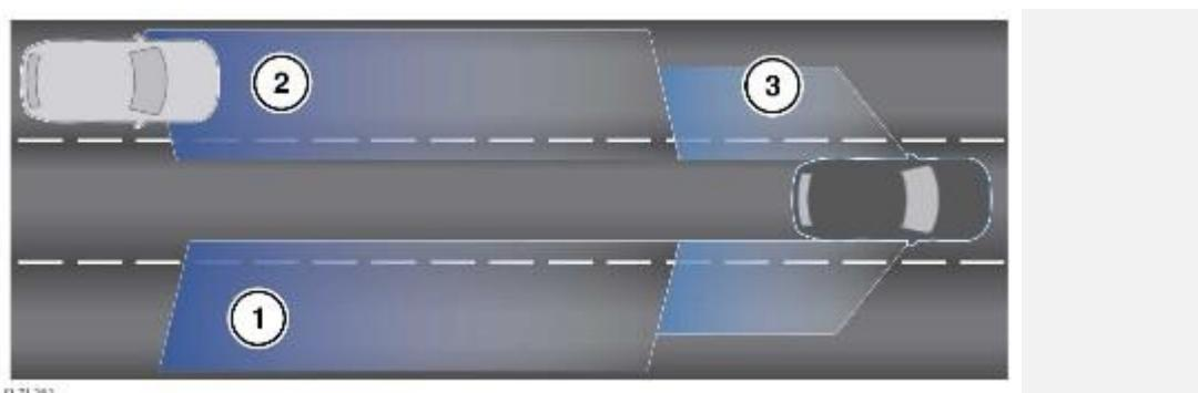
1. Контролируемая область позади и с обеих сторон автомобиля: функция обнаружения приближающегося автомобиля выполняет контроль области протяженностью до 70 м и шириной около 2,5 м от боковых частей автомобиля (ширина стандартной полосы движения).
