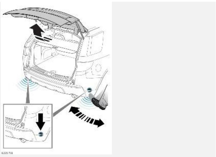
Датчики расположены в наружной части заднего бампера. Датчики распознают движение ноги ниже уровня бампера и обеспечивают автоматическое открывание или закрывание двери багажного отделения с электроприводом.
