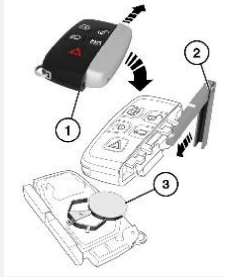
Уменьшение эффективного радиуса действия свидетельствует о необходимости замены элемента питания и сопровождается появлением на панели приборов сообщения **Smart Key Battery Low** (Разряжен элемент питания электронного ключа).
