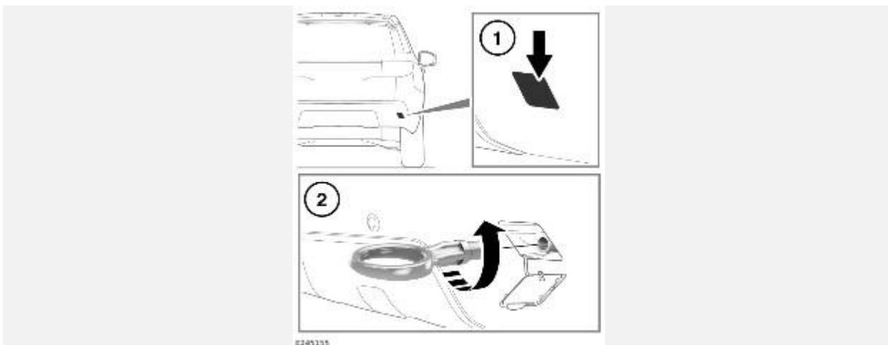
1. Снимите крышку доступа, нажав на нижний край, чтобы высвободить фиксатор. Крышка закреплена на бампере с помощью крепежного ремешка, но ее можно отсоединить, чтобы убрать в безопасное место.
