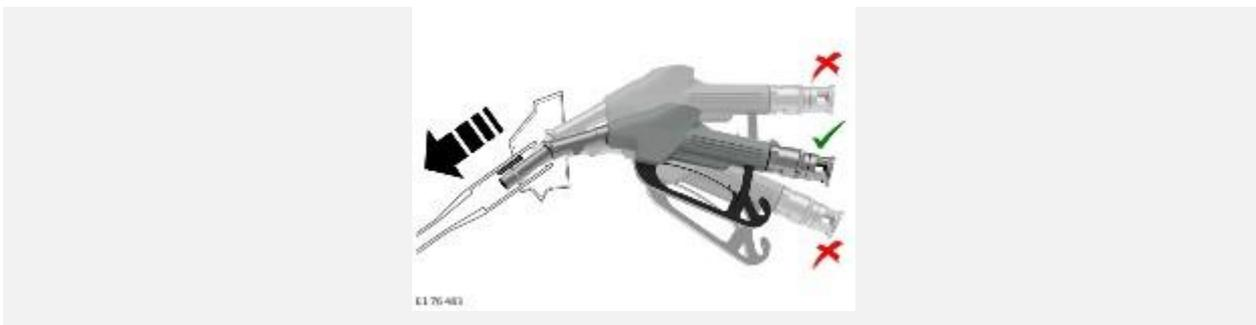
Автомобили с дизельным двигателем могут быть оснащены активным устройством топливной защиты. Металлический лючок виден в горловине топливного бака, когда снята крышка. Активное устройство топливной защиты помогает предотвратить залив в топливный бак топлива ненадлежащего типа, например, бензина. Автоматическое устройство обеспечивает доступ, если заправочный пистолет дизельного топливного насоса имеет надлежащий
