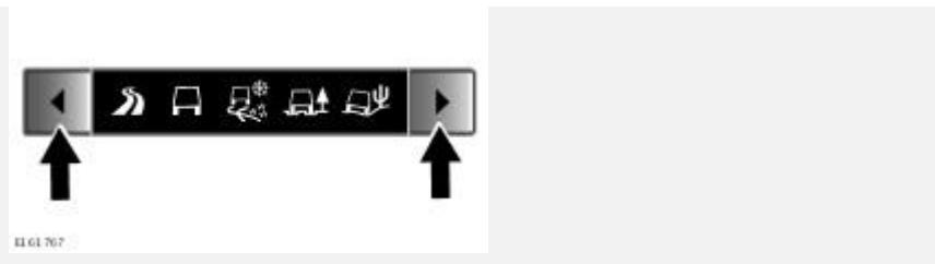
Используйте кнопки, расположенные на центральной консоли, чтобы переключаться между различными программами системы адаптации к дорожным условиям Terrain Response.
