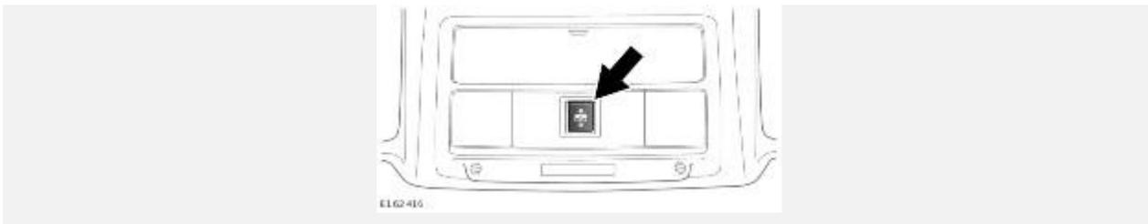
Переключатель открывания и закрывания шторки крыши:
