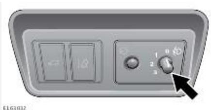
Угол наклона фар должен соответствовать загрузке автомобиля. Поворотный переключатель расположен в нижней части панели приборов со стороны водителя. Нажмите показанный на изображении переключатель, чтобы разблокировать его, а затем поверните в необходимое положение.
